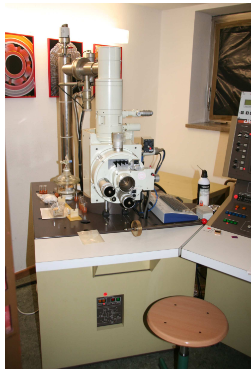
Abb. 2: Fotografie des schuleigenen Rasterelektronenmikroskops JEOL JSM - M 840
